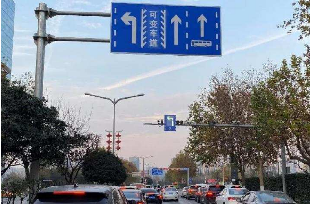
图9-1 可变车道标识牌示意图
